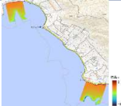
UAV搭載ALB測量による 海底地形標高画像データ
