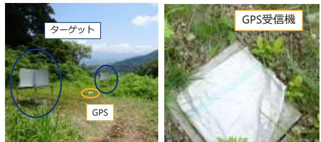
図7 GPSの設置状況
